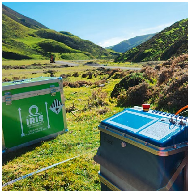
Résistivimètre de nouvelle génération SYSCAL TERRA, utilisé par RDCL en Nouvelle-Zélande. © ALISTAIR STRONACH
