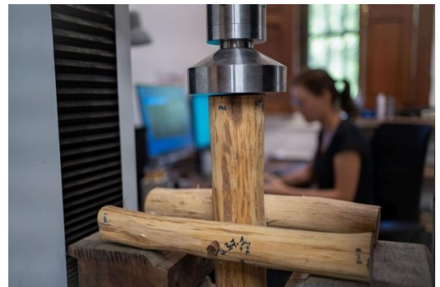
Test de résistance du bois rond, CIRAD Kourou
