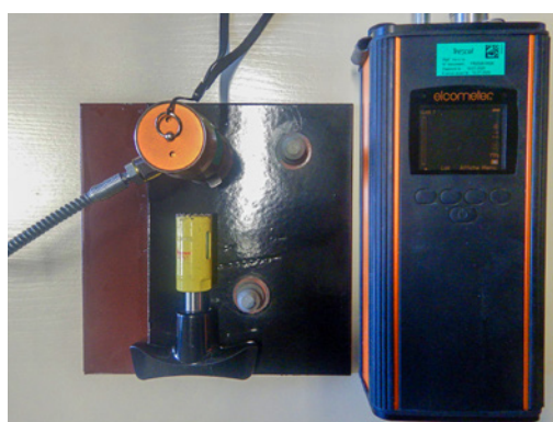
Figure 5 : opérations liées au diagnostic de la peinture existante sur un pont métallique.
