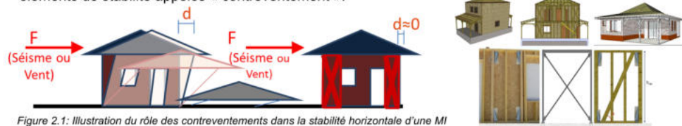
Figure 2.1: Illustration du rôle des contreventements dans la stabilité horizontale d'une MI
