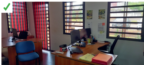
Le bureau est installé perpendiculairement aux fenêtres. Les ouvertures en face du bureau sont protégées par l'ajout de stores pour limiter les risques d'éblouissement. ©AQC
