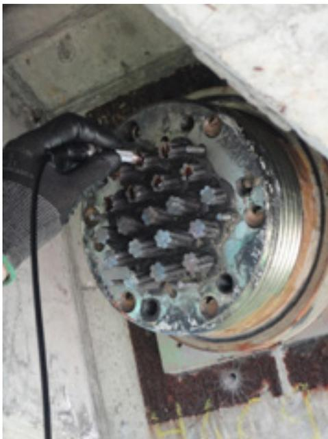
◀ Figure 39 - L'accès aux extrémités des torons constitutifs des haubans permet de tester leur continuité (pont de Bourgogne à Chalon-sur-Saône et procédé UScan® de Sixence).
