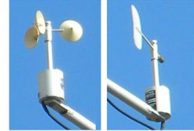
Figure 3.11 – Les capteurs VECTOR INS.
