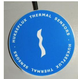
Figure 3.5 – Le fluxmètre HUKSEFLUX
