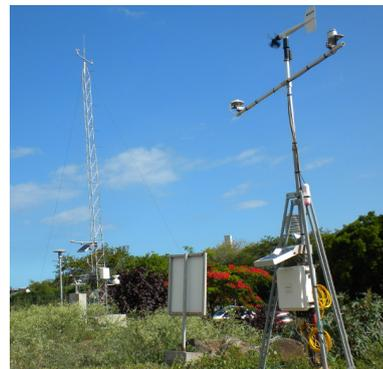
Figure 1.4 – Les deux stations météorologiques : « fixe » et « portable »
