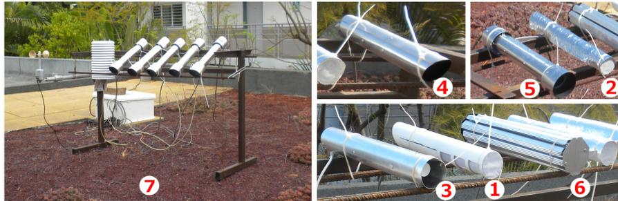
Figure 4.9 – Banc d'essai et prototypes de protection testés.
