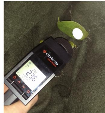
**Figure D.2** – Mesure de l'émissivité en la surface d'une feuille
