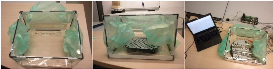
Figure 4.1 – Module développé pour l'ajustage des sondes hygrométriques.
