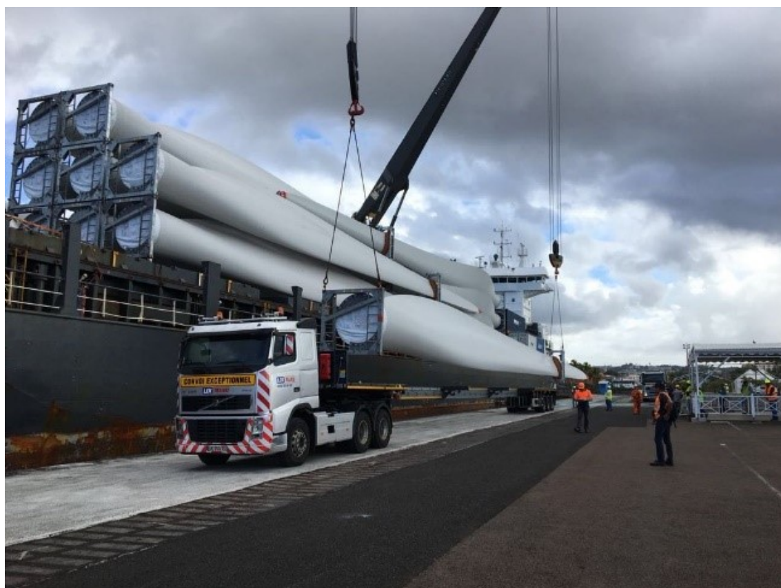
Figure 90 Déchargement des pales des éoliennes terrestres sur le port de Fort-de-France en 2018 (Source : JDL Groupe)
